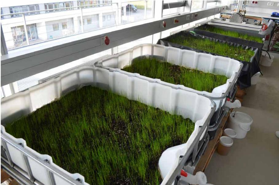
Laborversuche an der Hochschule Magdeburg-Stendal: hier sind bereits die verschiedensten Ersatzbaustoffe wie Porenbetonbruch und Leichtbetonauf ihre „Begrünungsfähigkeit“ untersucht worden. Bild: HS Magdeburg.
