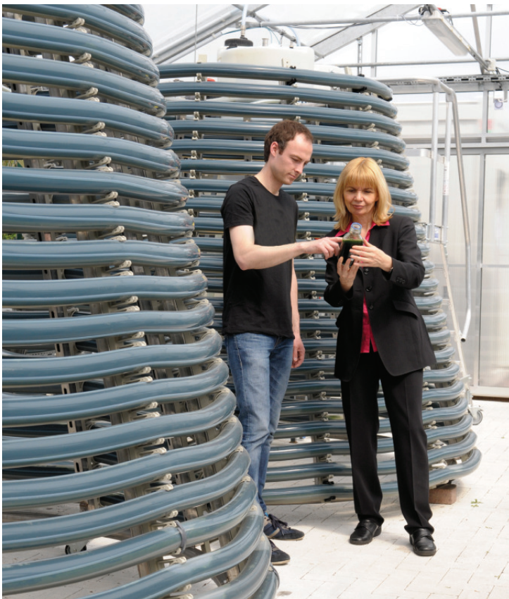
Prof. Carola Griehl und Doktorand Stefan Matthes vor den sogenannten Tannenbaum-Reaktoren zur Produktion von Algen-Biomasse.
