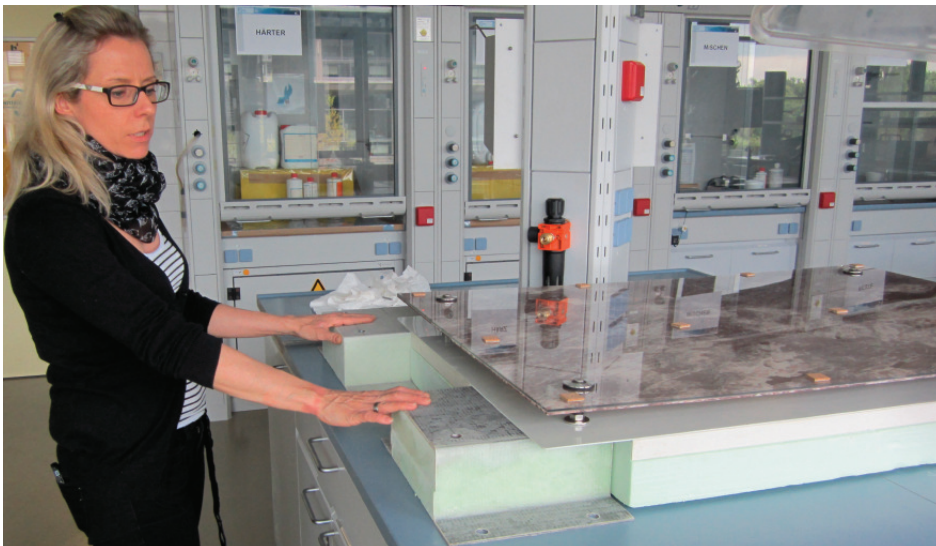
Julia Hosse erklärt das innovative Leichtbaufassadenelement. Hier im Industrielabor „Funktionsoptimierter Leichtbau“ wurde die optimale Verbindung von Glas und Naturstein gefunden.
