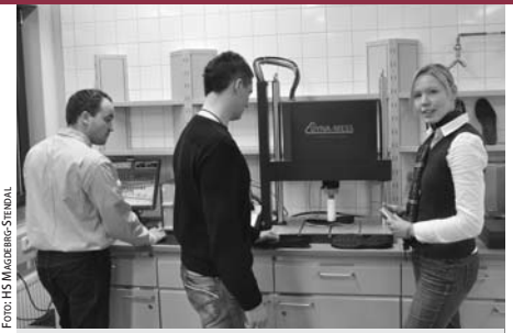
Prüfung der Dämpfungseigenschaften von Sohlenmaterialien.
