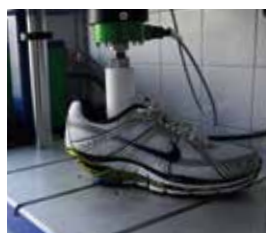
Dynamische Prüfung des Heelless-Schuhs, HS Magdeburg-Stendal
