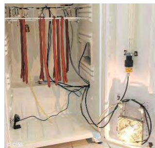
Abb.: prototypische Rohwurstreifeanlage im Labormaßstab mit multiplen Sensoren © CFSE
