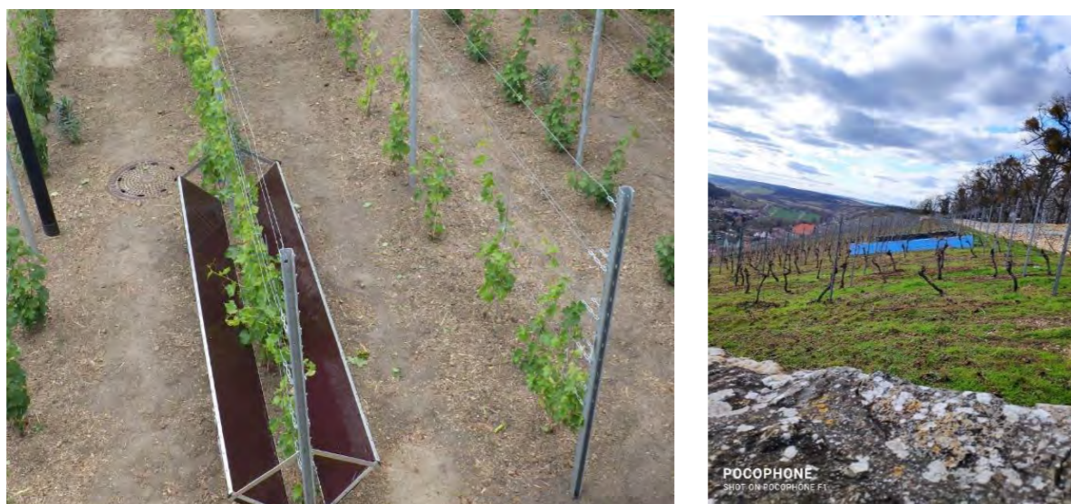
Abb. : Weinbau-Versuchsanlage mit Folienhaltergestell und entwickelten Mehrschichtfolien (links Mitteldeutschen Instituts für Weinbau am Standort Köthen; rechts Winzervereinigung Freyburg)
