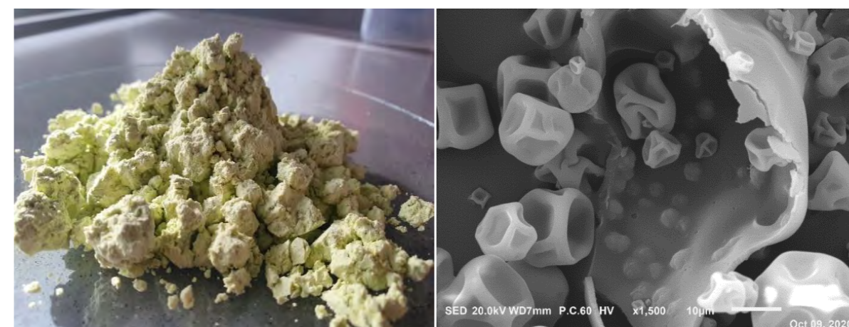
Abb: Mikroverkapseltes Algenpulver für den Einsatz in funktionellen Getränken (rechte Abbildung: REM-Aufnahme mit Ansicht der verkapselten Mikroalgen auf der Wandinnenseite der Mikrokapsel)
