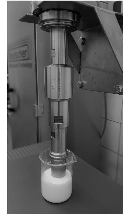
Abb: Ultraschallanlage zur Beschallung von milchbasierten Flüssigkeiten.
