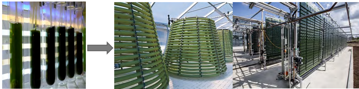
Abb. 5: Kultivierung in Photobioreaktoren im Labor- und Pilotmaßstab an der HS Anhalt, Pilotanlage am Fraunhofer CBP in Leuna
