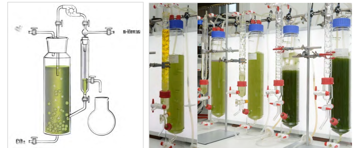
Abb. 2: Einsparung der Aufarbeitungsschritte Ernte, Trocknung und Zellaufschluss gegenüber einer herkömmliche Prozesskette zur Gewinnung von Ölen/Produkten aus Mikroalgen
