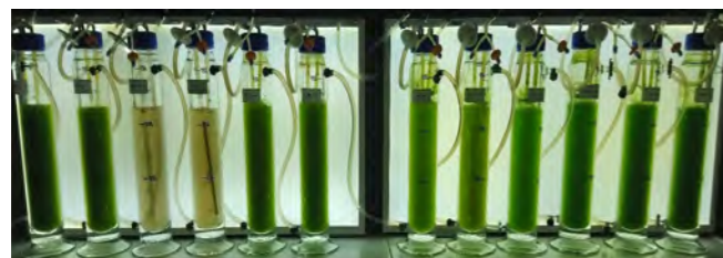
Abb. 2: Kontaminationsexperimente verschiedener Algenkulturen in Blasensäulen, Bakterienisolate aus Algenkulturen (unten)
