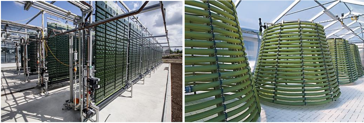
Bild 6: Kultivierung in Photobioreaktoren am CBP (links) und an der Hochschule Anhalt (rechts) (Bilder: HS Anhalt)
