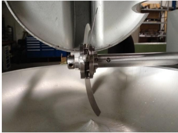
Bild 4: Entwickelter verstellbarer Aufsatz mit den gebogenen und geneigten Kuttermessern (Foto: HS Anhalt)
