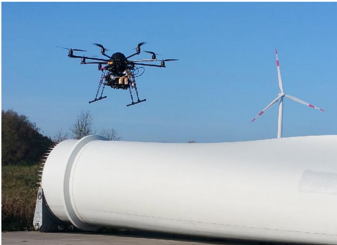
Bild 14: InspektoKopter-Prototyp bei der Rotorblattbefliegung einer Windenergieanlage (Foto: Netzwerk InDiWa, FuE-Projekt InspektoKopter)
