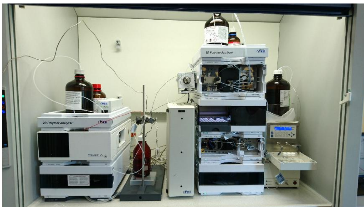
Bild 19: 2D-Chromatographie-Anlage (HPLC/GPC-Kopplung) (Foto: HS Merseburg)
